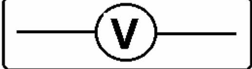
شكل رمز جهاز الفولتميتر
